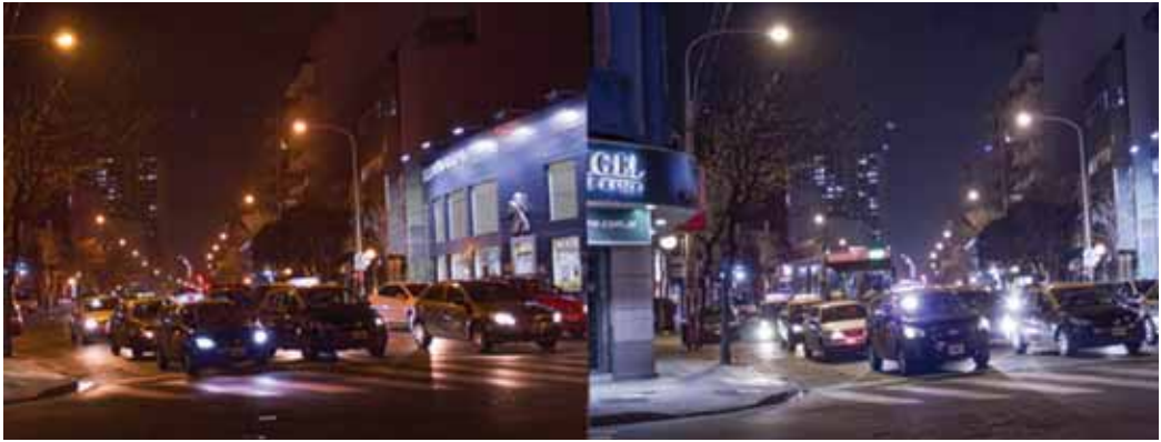
Imagen de una calle de Buenos Aires, antes del cambio a LED (izquierda) y después (derecha). El cambio a LED ha mejorado la iluminación y cambiado la estética por los tonos más blancos del mismo, además de reducir el consumo eléctrico. Fuente: Web de la ciudad autónoma de Buenos Aires
